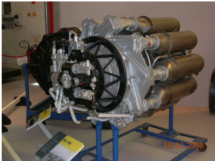
Triebwerk Whittle W2/700 in Cosford (Bild Peter Horstmann)
